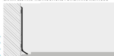
USE PROBAND FIX FOR FIXING THE PROFILE TO THE WALL
