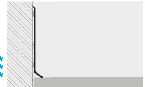
USE PROBAND FIX FOR FIXING THE PROFILE TO THE WALL
