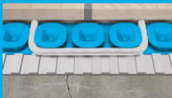
UNCOUPLING / CRACK ISOLATION
