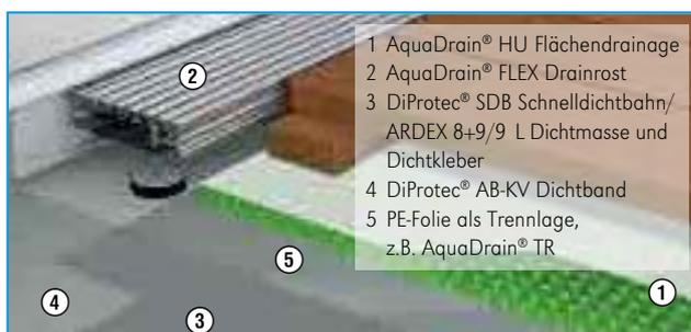
Aqua Drain® HU ist eine hochbelastbare und gleichzeitig kapillarpassive Flächendrainage – speziell entwickelt für die lose Verlegung auf ungebundenen Untergründen. Im Gegensatz zu konventionellen Noppenbahnen ist Aqua Drain® HU unterseitig gelocht: Sickerwasser kann daher auch bei unebenem Planum abfließen.
