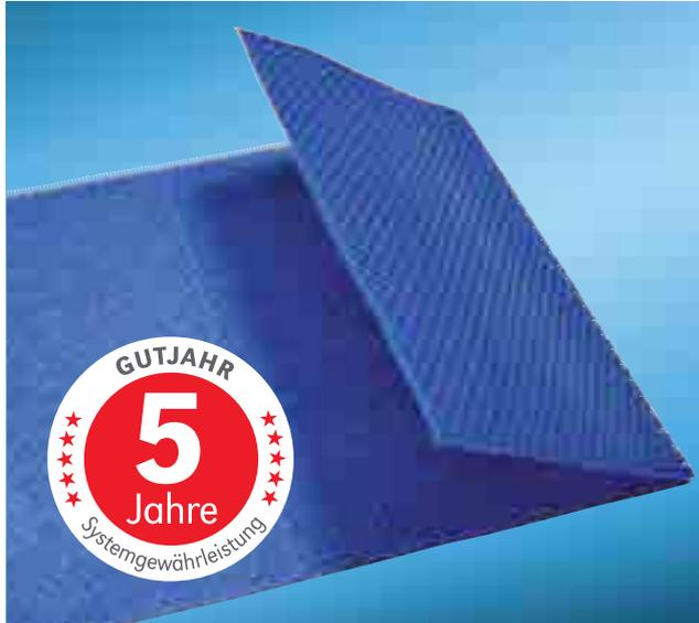
Watec® Drain KP+ ist die einzige kapillarpassive Dünnschichtdrainage, die lose, also ohne Verbund zum Untergrund verlegt wird. Die 100%ige Entkopplung und Entwässerung sorgt dafür, dass Frostschäden und Ausblühungen vermieden werden und dass das Abtrocknen der Konstruktion wesentlich beschleunigt wird. Die Aqua® Drain VARIO Kastenrinne ermöglicht regelgerechte Türanschlüsse auch bei niedrigen Anschlusshöhen.
