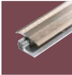
TRIFLOOR ist das extra-stabile Systemprofil für Belagshöhen von 7 - 17 mm. Die 3-teilige Konstruktion aus stabilem Aluminium-Trägerprofil, der bewährten Omega-Wipptechnik und dem Aluminium-Topprofil, bietet einheitliches Design und zuverlässige Technik auf allen Belägen.
